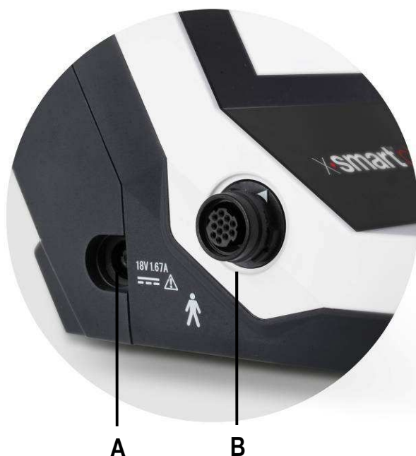
Fig. 4 Connettori alimentazione e manipolo del motore
