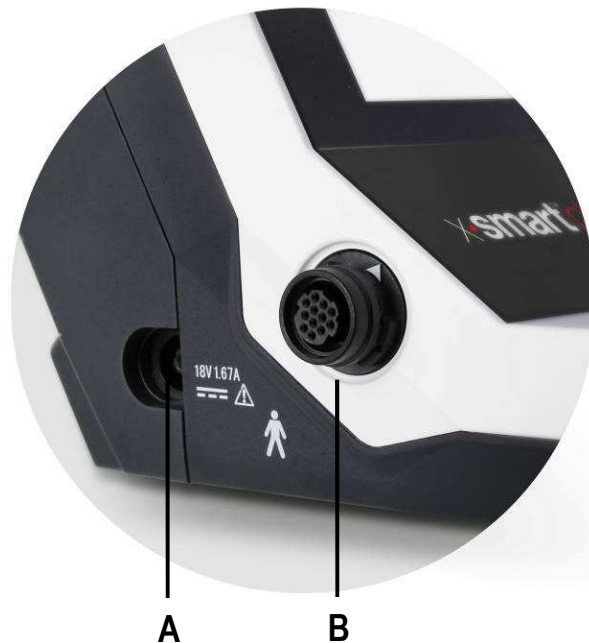
Abb. 4 Anschlüsse für Stromkabel und Motorhandstück
